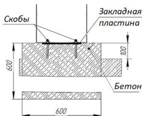
Шлагбаум следует установить на фундамент размером 600x600x600 из бетона марки не ниже М400. При заливке необходимо использовать монтажный комплект: монтажную пластину и скобы, при этом скобы должен выступать над поверхностью фундамента своей резьбовой частью на высоту не менее 40 мм. Сам фундамент должен выступать над уровнем проезжей части не менее 100мм
